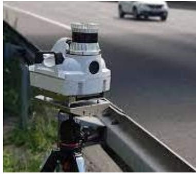
Avec une portée qui peut atteindre 100 mètres (contre 50 mètres pour les anciens modèles) et une fréquence de mesure de plus d'un véhicule par seconde en rapprochement comme en éloignement, ce nouveau radar est un outil qui doit permettre un meilleur contrôle du respect de la vitesse.
